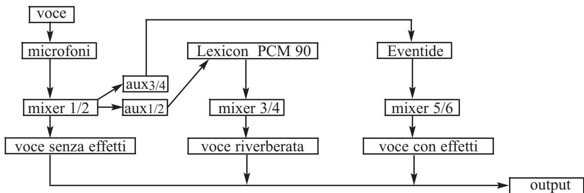
Il mixer deve avere minimo 6 linee bilanciate di ingresso (2 delle quali con alimentazione +48V), una uscita stereo e 4 uscite ausiliarie, due delle quali con opzione pre-fade.
